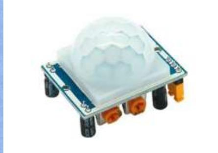
Dieser Infrarotsensor gibt bei Erkennung einer Bewegung auf seinem Datenpin eine Spannung von 3,3 V aus. Dabei sendet der Sensor Wellen an seine Umgebung aus, welche an Hindernissen reflektiert werden und wieder zurück zum Sensor gelangen. Die ankommenden Wellen wertet der Sensor anschließend aus. Die Auswertung der zurückgekommenen Wellen ergeben verschiedene Ergebnisse, wenn sich ein Hindernis bewegt. Dadurch kann der Sensor eine Bewegung feststellen.
