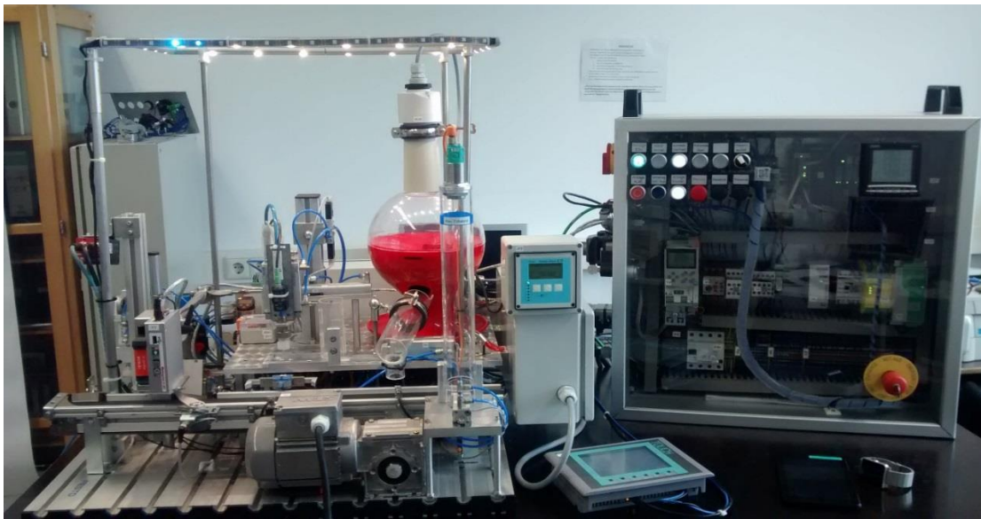
Abbildung 2.1: Gesamte M&M-Abfüllanlage mit allen Komponenten
